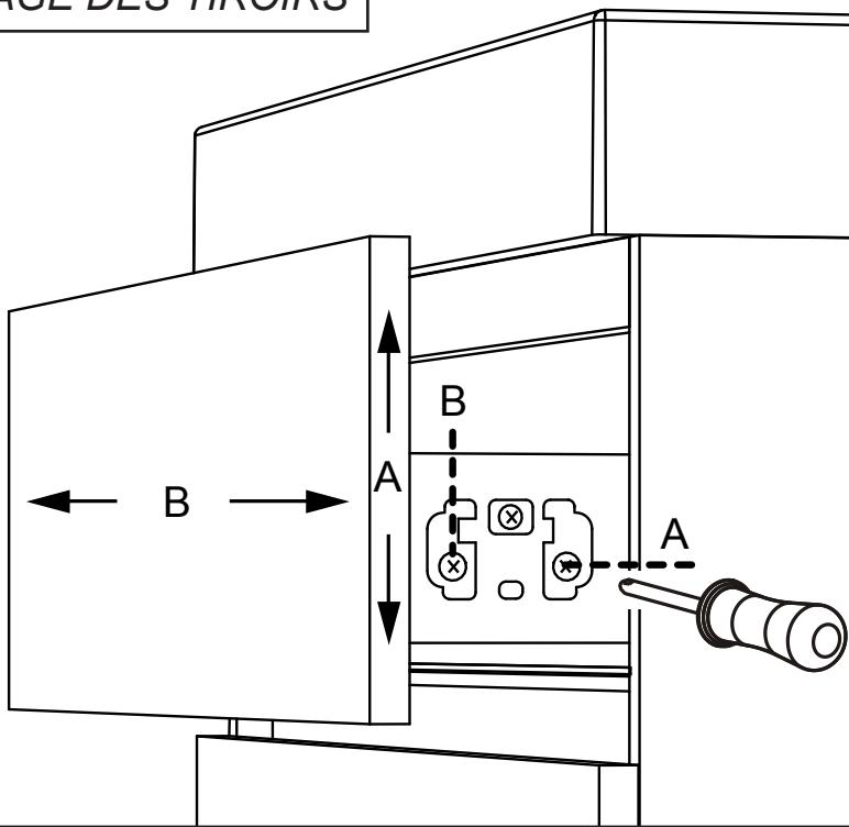
Verwijder eerst de afdekplaatjes aan de zijkanten van de lades om het stelmechanisme te bereiken.
