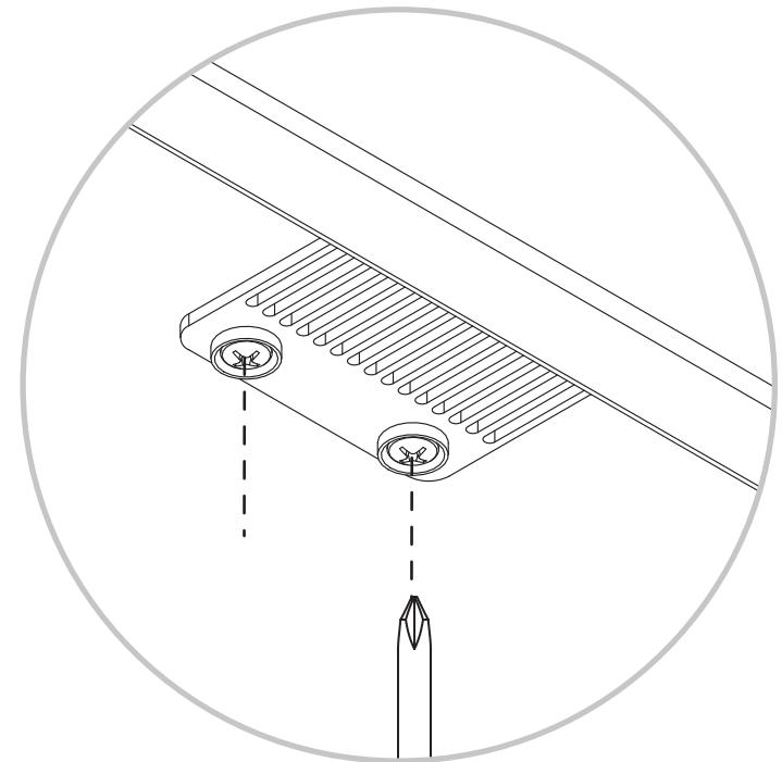
Voor laden breder dan 90 cm: draai de twee schroeven van de frontstabilisering los om het ladefront te kunnen verwijderen.
