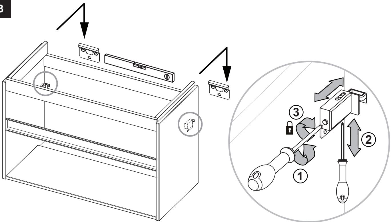
(NL) Gebruik de ophanghaken om de onderkast waterpas aan de muur te hangen. Rechtsom draaien (3) klemt de kast tegen de muur aan.
