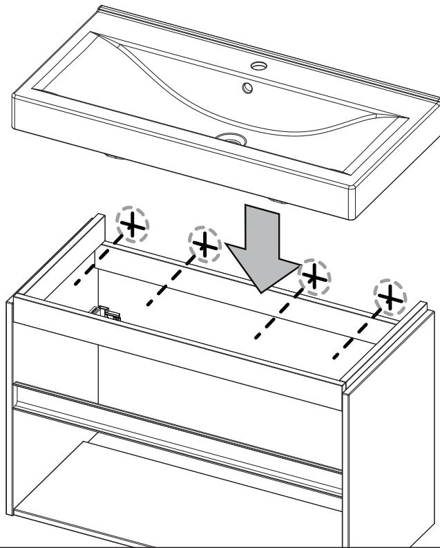
(NL) Plaats de wastafel terug op de kast en bevestig deze met wastafelbouten (niet meegeleverd!) aan de muur. Draai eventueel nog de beugels op de onderkast aan (zie stap 3). Tip: bevestig de kraan voordat u de wastafel op het meubel plaatst.
