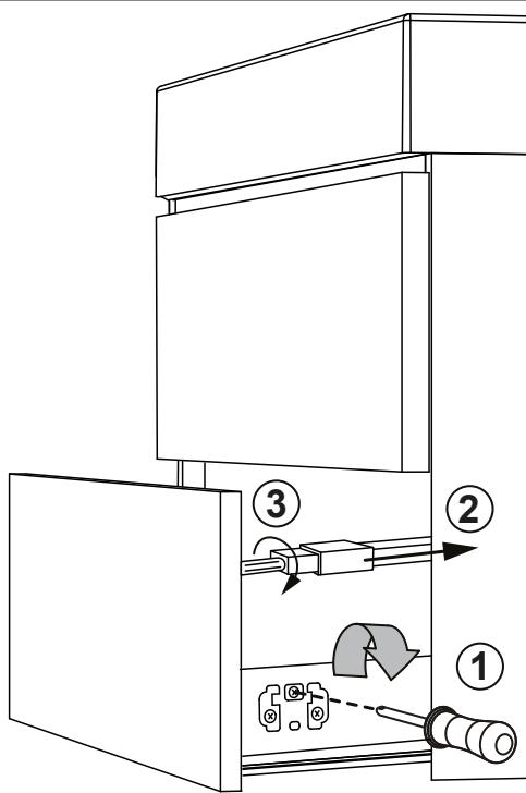
1. Draai de kruissleuf "C" aan weerszijden van de lade rechtsom om het frontpaneel te ontkoppelen.
