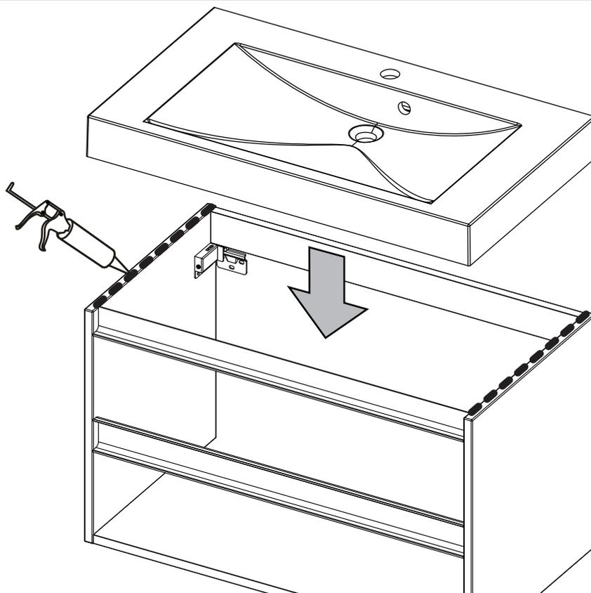
(NL) Breng kit aan op beide zijpanelen en plaats de wastafel op de kast. Tip: monteer de kraan en afvoerplug voordat u de wastafel op het meubel plaatst.
