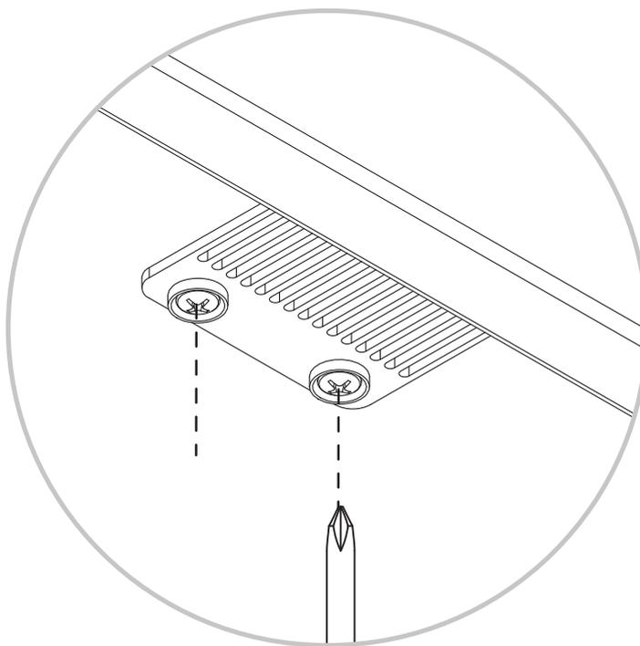
Voor laden breder dan 90 cm: draai de twee schroeven van de frontstabilisering los om het ladefront te kunnen verwijderen.
