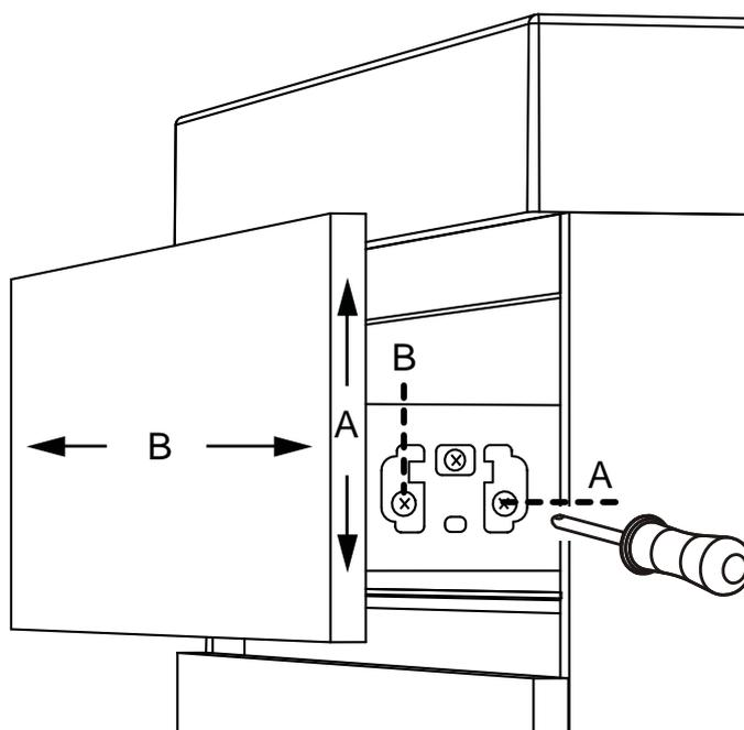
Verwijder eerst de afdekplaatjes aan de zijkanten van de lades om het stelmechanisme te bereiken.
