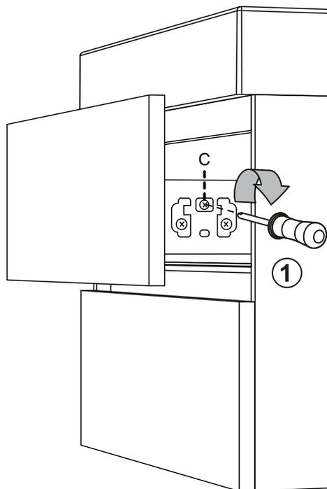
Draai de kruissleuf "C" aan weerszijden van de lade rechthoekig om het frontpaneel te ontkoppelen.
