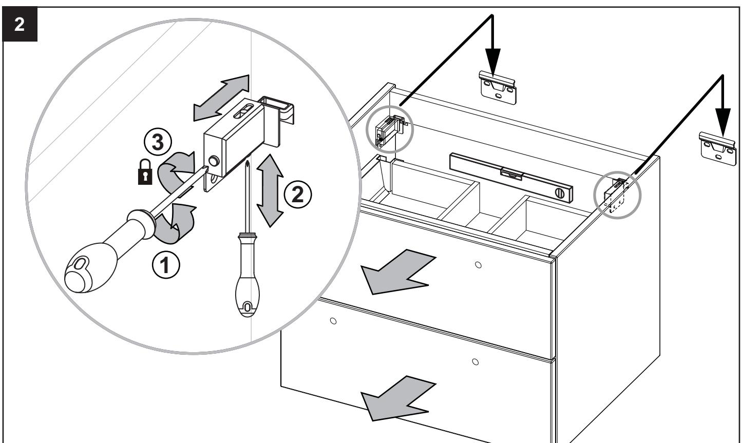
(NL) Gebruik de ophanghaken om de onderkast waterpas aan de muur te hangen. Rechtsom draaien (3) klemt de kast tegen de muur aan. Tip: verwijder de lades (blz. 7) om het ophangen van de kast te vergemakkelijken.
