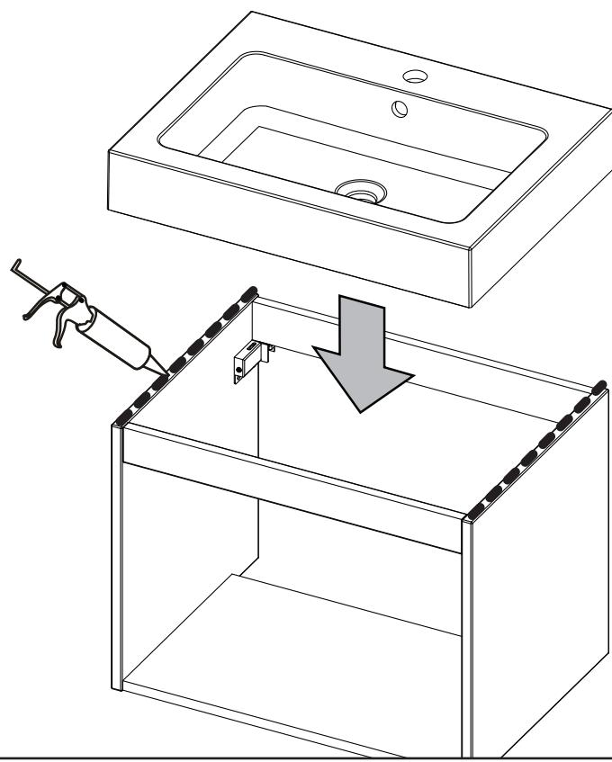
(NL) Breng kit aan op beide zijpanelen en plaats de wastafel op de kast. Tip: monteren de kraan en afvoerplug voordat u de wastafel op het meubel plaatst.
