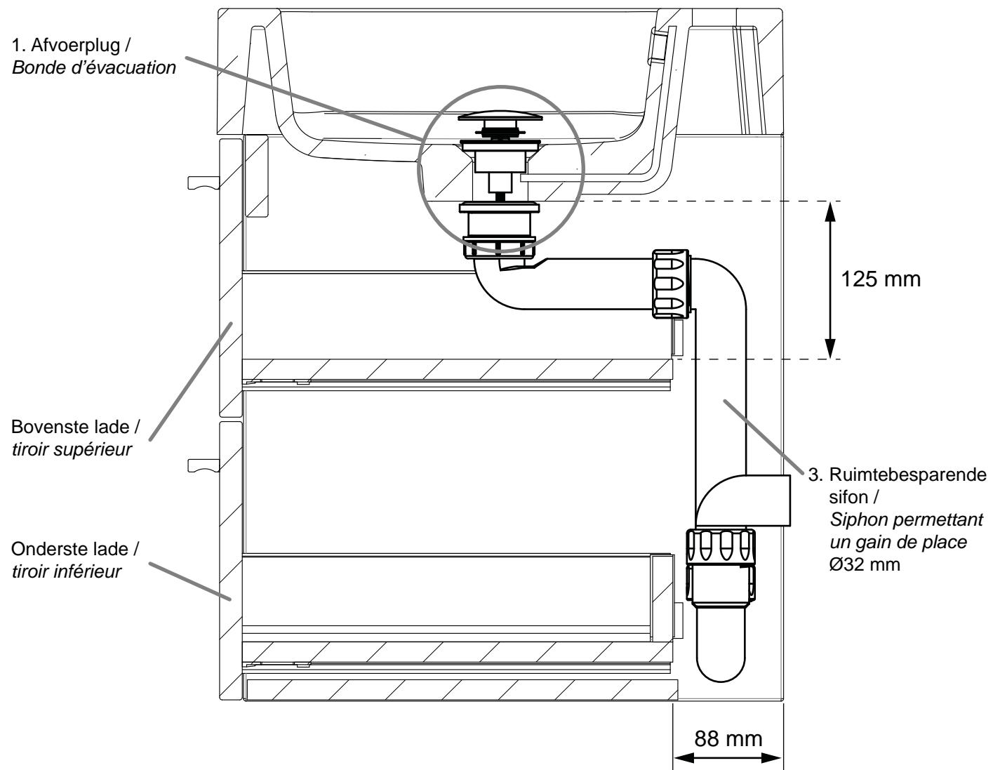
(NL) Om de afvoer aan te sluiten dienen de volgende elementen aanwezig te zijn:
